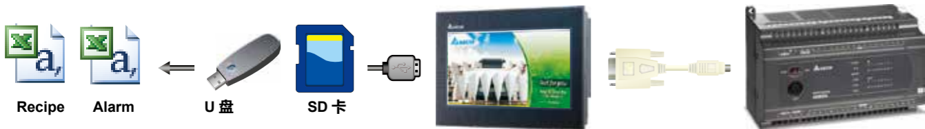
可将生产历程数据或是警报数据以 CSV 格式储存于 SD 卡 / U 盘。
