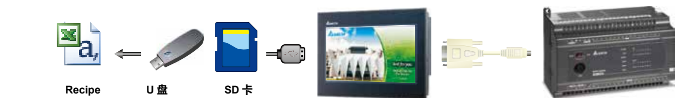
将生产配方数据以 CSV 格式储存于 SD 卡 / U 盘中，有效节省 PLC 内存空间，并方便于 PC 上以 Excel 编辑。
